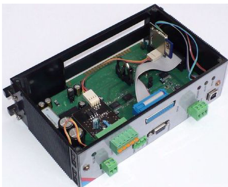
Obr. B.1: Řídicí modul - sestava řídicí desky a přídatných desek
