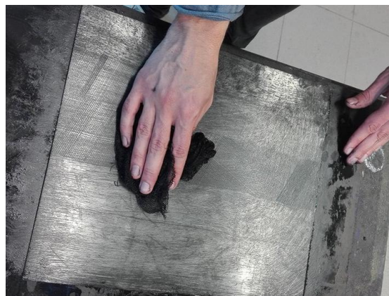
Obr. 45: Zatírání tiskařské barvy do zhloubených míst tiskové formy pomocí gázy
