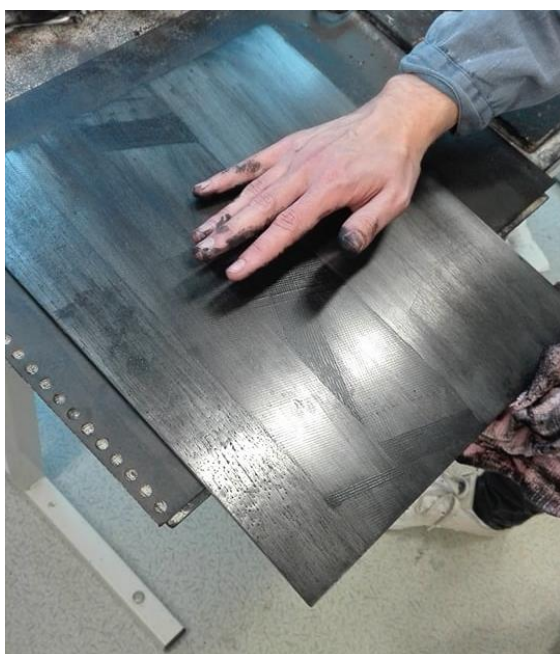
Obr. 46: Stírání tiskařské barvy z povrchu tiskové formy
