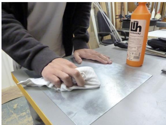
Obr. 29: Odmaštění tiskové desky lihem
