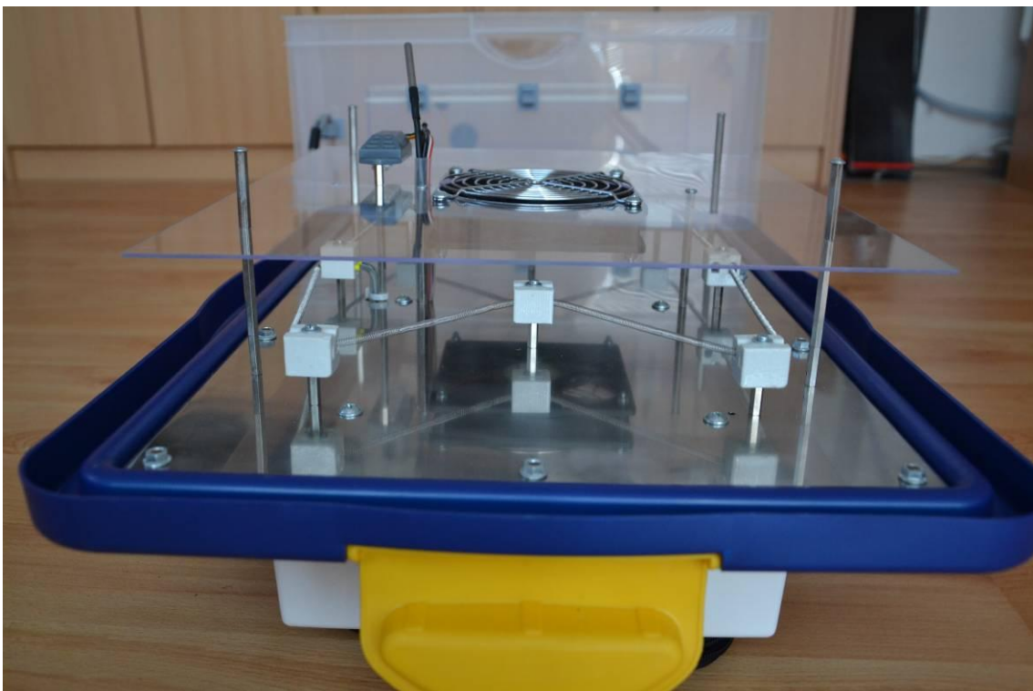
Obrázek 73 Pohled na spodní část víka lihně, na ventilátor cirkulace, topnou spirálu a čidla digitálních měřicích přístrojů - foto 2
