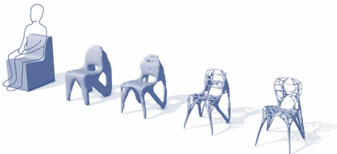
Obr. 1 Ukážka priebehu topologickej optimalizácie stoličky [8]
