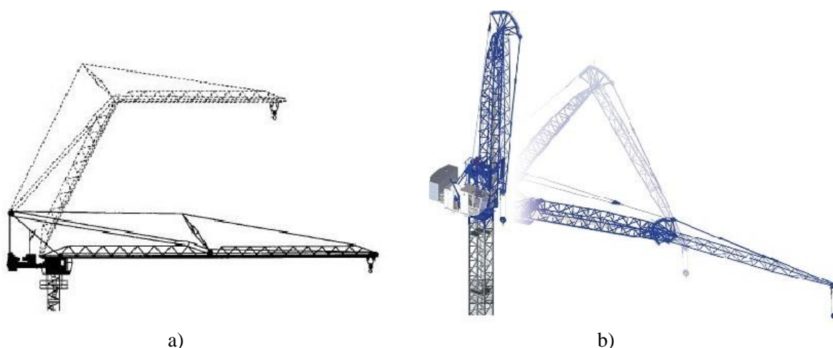
Obr. 6 Lomený výložník s 2. výložníkovou časťou: a) vodorovnou, b) sklopnou [58],[51]
