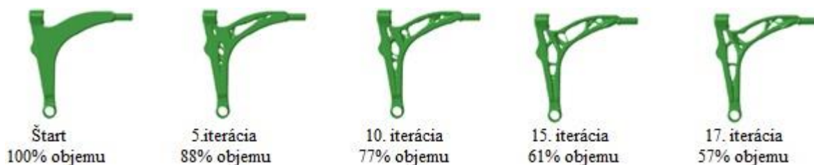
Obr. 20 Iteračný proces topologickej optimalizácie [54]
