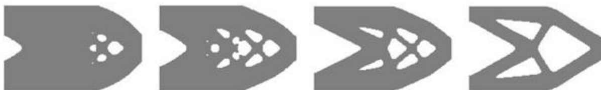
Obr. 29 Priebeh topologickej optimalizácie metódou BESO [7]
