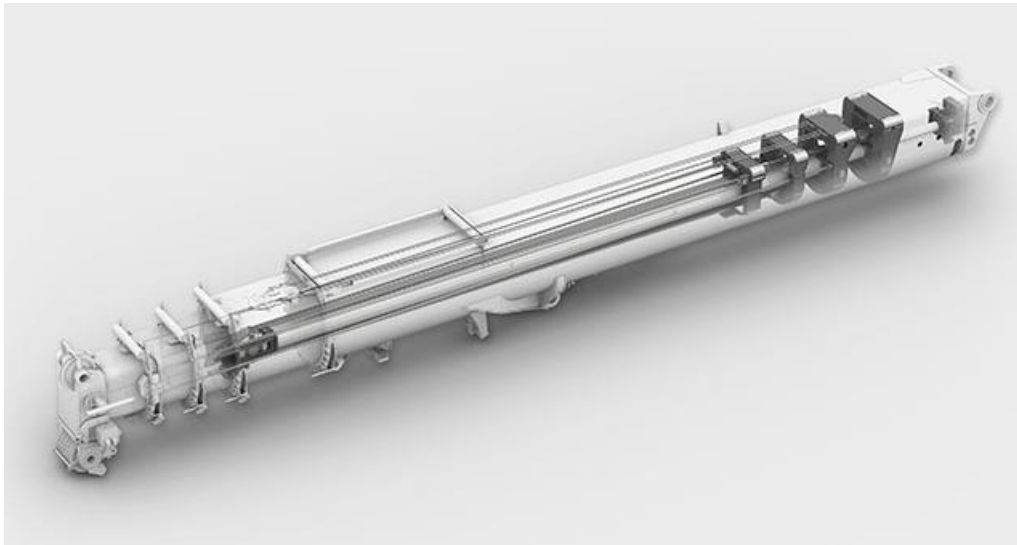
Obr. 14 Teleskopický výložník s hydromechanickým systémom so štyrmi vysúvacími dielami [35]
