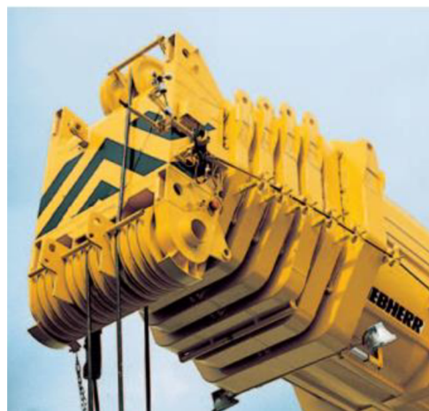
Obr. 11 Vystuženie koncov jednotlivých dielov výložníka [37]
