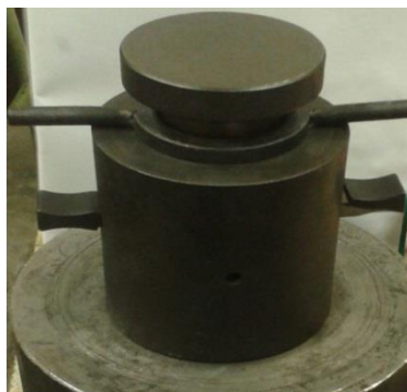
Obr. 42 Nástroj pro pēchování
