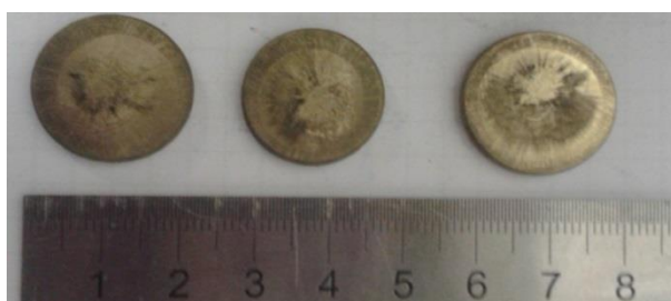
Obr. 39 Vzorky zpěchované na stroji CZR 600
