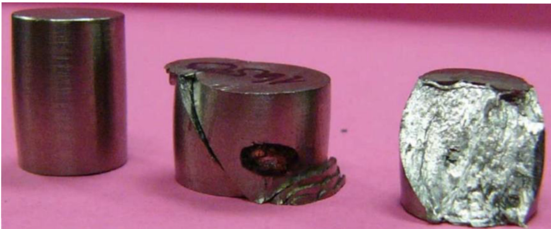
Obr. 11 Lom při pěchování tělesa [15]
