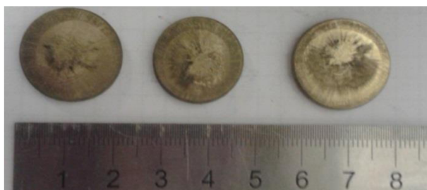
Obr. 39 Vzorky zpěchované na stroji CZR 600
