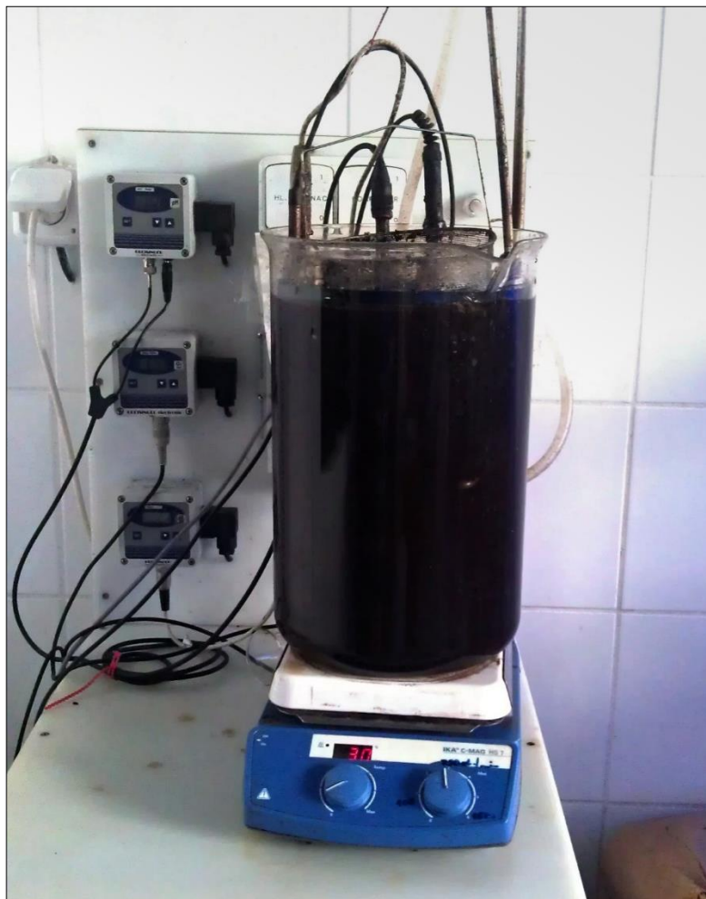
Příloha č. 15: Zařízení na výrobu vodných výluhů z vermikompostů (Zdroj: Drešlová)
