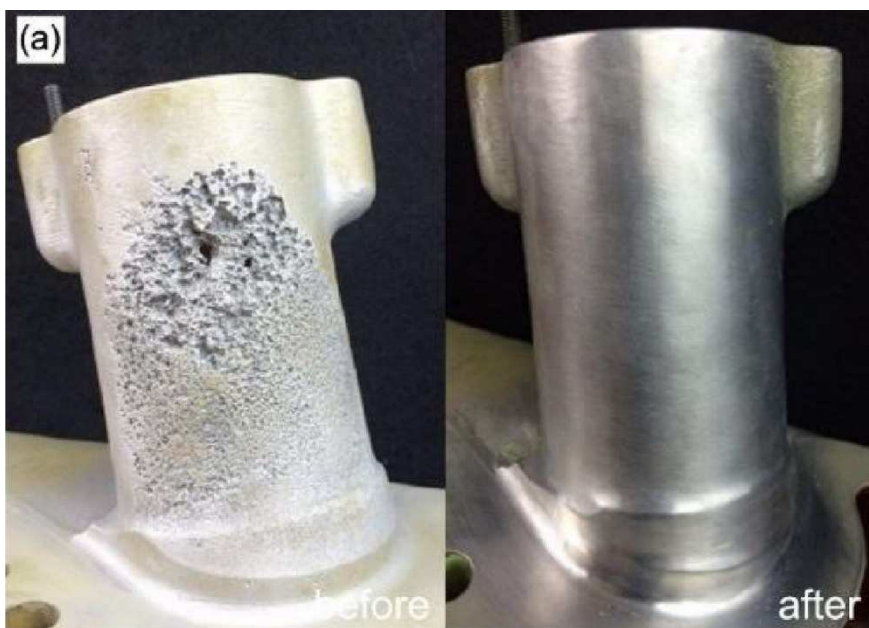
Obrázek 7: Obrázek součásti před a po opravě pomocí studeného nástříku [16]
