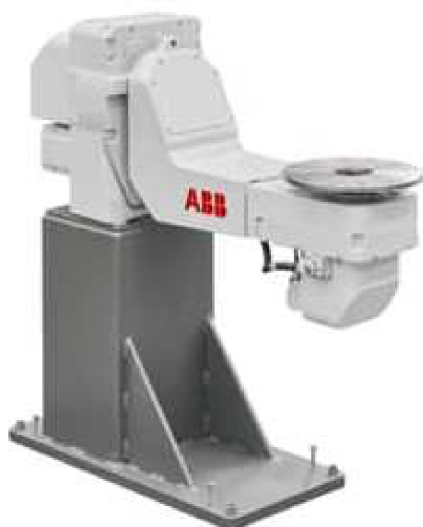
Obrázek 13: Polohovadlo ABB IRBP A-250 [24]
