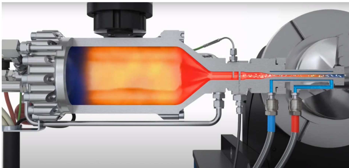
Obrázek 15: Průřez tryskou pro studený nástřík od firmy Impact [34]
