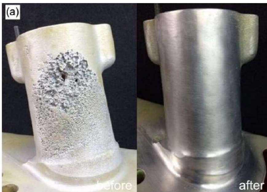
Obrázek 7: Obrázek součásti před a po opravě pomocí studeného nástřiku [16]
