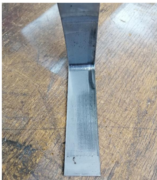
Obr. 6.7: Poškození pásku plechu.
