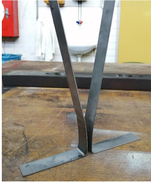
Obr. 6.8: Plastická deformace pásku plechu.
