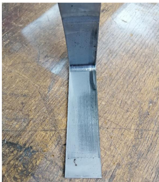
Obr. 6.7: Poškození pásku plechu.
