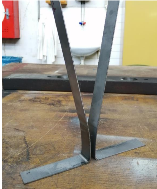
Obr. 6.8: Plastická deformace pásku plechu.
