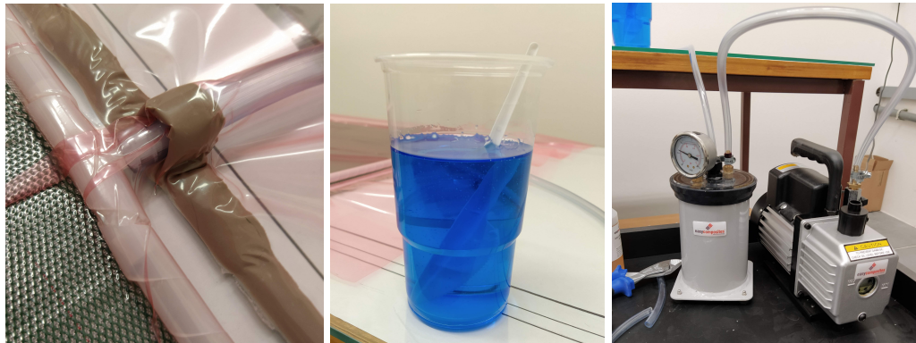
Obrázek 4.6: Těsnění, pryskyřice a vývěva s nádobou pro přebytečnou pryskyřici.
