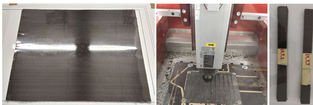
Obrázek 4.8: Kompozitní deska po laminaci, frézování vzorků a obrobeneé tahové vzorky.
