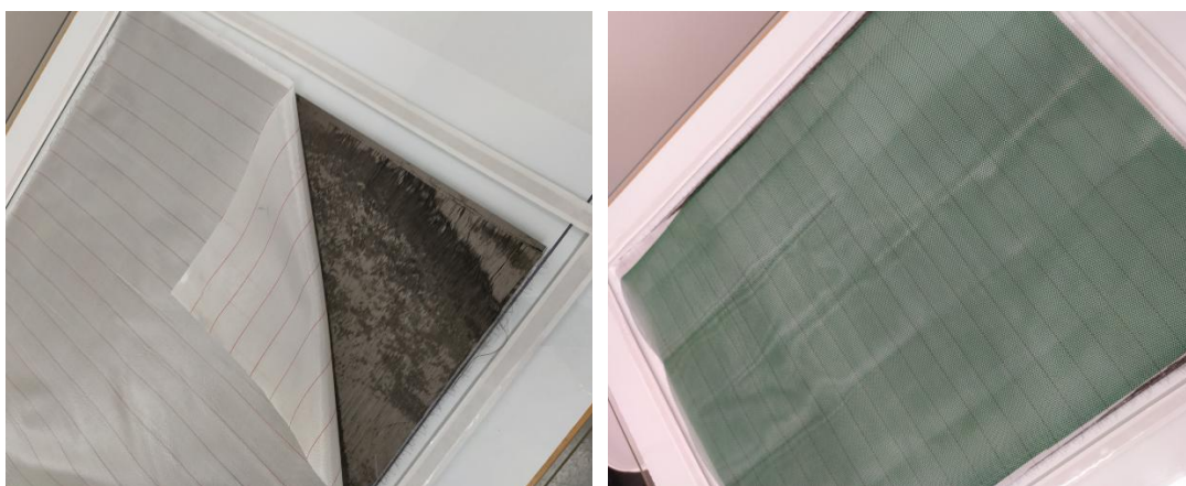
Obrázek 4.5: Vlevo: odtrhová vrstva. Vpravo: rozvodná mřížka.
