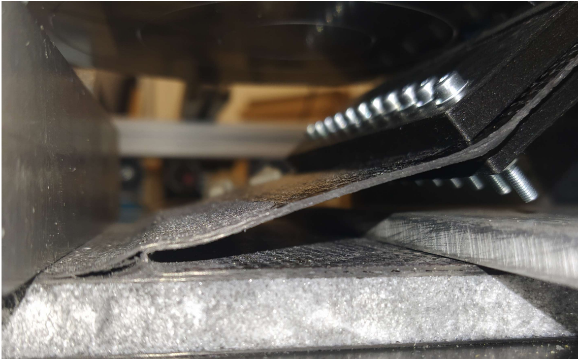
Obrázek 10.4: Delaminace mezi spodním a středním skinem.
