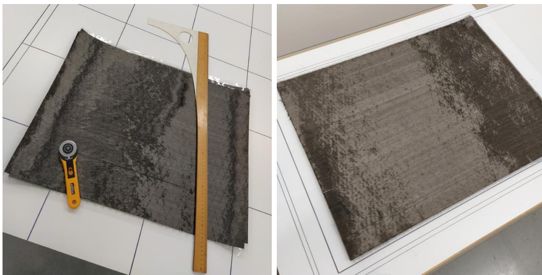
Obrázek 4.4: Vlevo: nařezaná UD vlákna. Vpravo: laminační stůl (skleněná tabule) a naskládaná UD vlákna - Layup 1.
