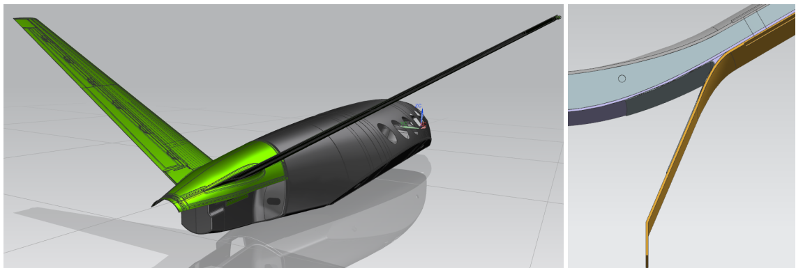
Obrázek 1.2: Uchycení ocasních ploch k trupu a detail vzpěry na letadle Alice.
