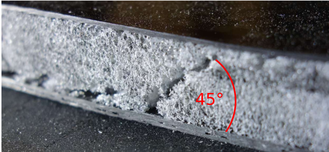
Obrázek 8.6: Detail praskliny v jádře.
