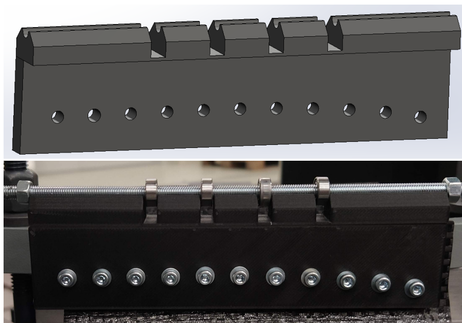
Obrázek 10.1: CAD model a vyrobený přípravek pro uchycení ložisek.
