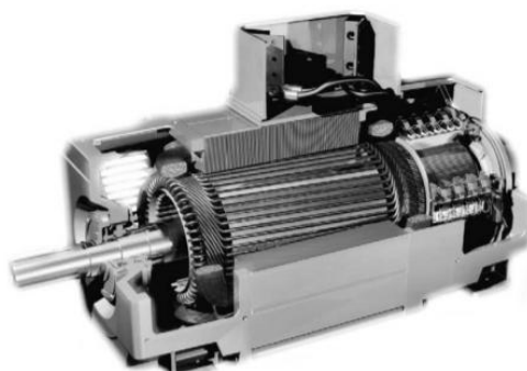
Obr. 2-25 Konvenční DC motor [20]
