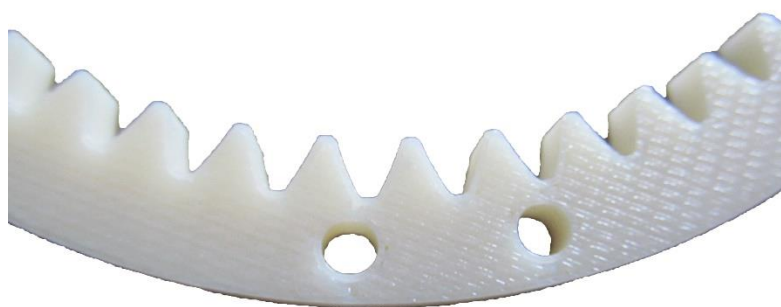
Obr. 2.34 Nerovnosti vytvořené procesem 3D tisku.
