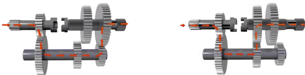
Obr. 1.4 Schéma předlokové převodovky s posuvnými koly [7].
