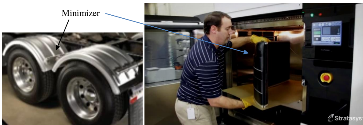
Obr. 3.6 Přímé užití blatníku Minimizer vyrobeném technologií RP [28].
