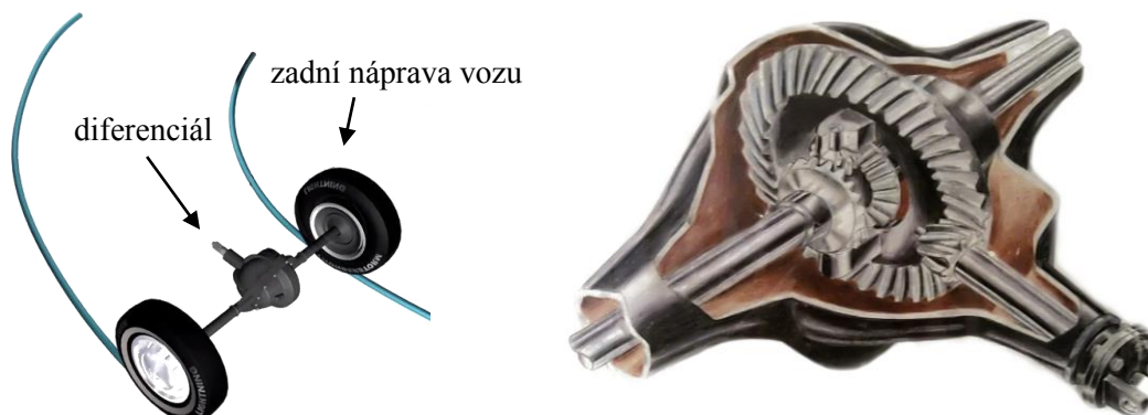
Obr. 1.7 Poloha diferenciálu ve vozidle [7, 11].
