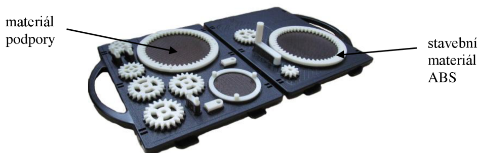
Obr. 2.31 Podložky vyjmuté z tiskárny uPrint.
