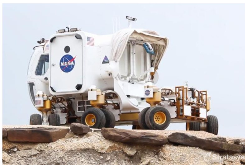
Obr. 3.7 Přímé užití technologie FDM pro vyhotovení cca 70 dílů vozidla Rover společnosti NASA [29].
