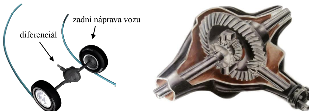
Obr. 1.7 Poloha diferenciálu ve vozidle [7, 11].
