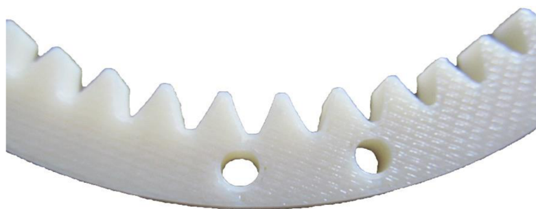
Obr. 2.34 Nerovnosti vytvořené procesem 3D tisku.
