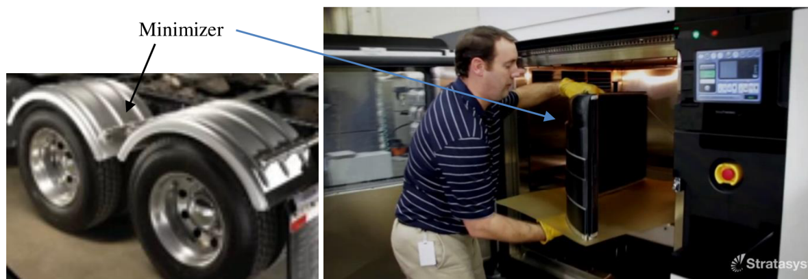
Obr. 3.6 Přímé užití blatníku Minimizer vyrobeném technologií RP [28].
