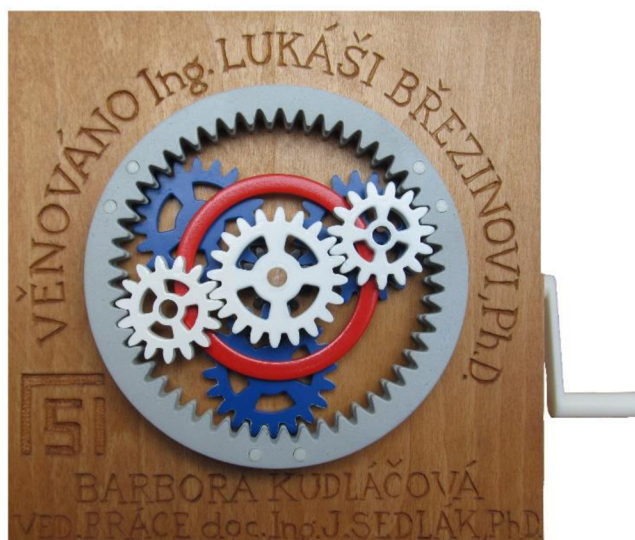
Obr. 2.35 Kompletní sestava planetového mechanismu.
