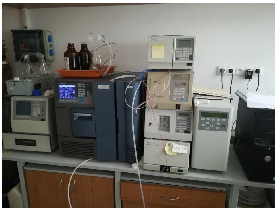
Obrázek č. 6: Kapalinový chromatograf firmy WATERS e2695 Zdroj: foto autor
