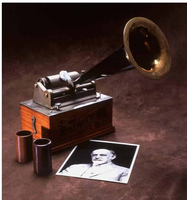
Obrázek 6 - Edison v fonograf vylepený J.W. Fewkesem o voskový válec, podobné zařízení používal i F. Boas http://www.loc.gov/exhibits/treasures/images/tlc0130.jpg
