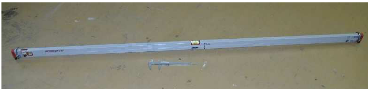
obr. 7.1a. Vodováha na měření rovinnosti
