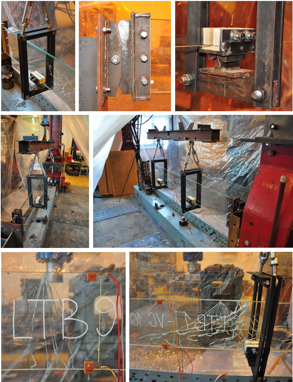
Detaily realizace okrajových podmínek, průběh experimentu
