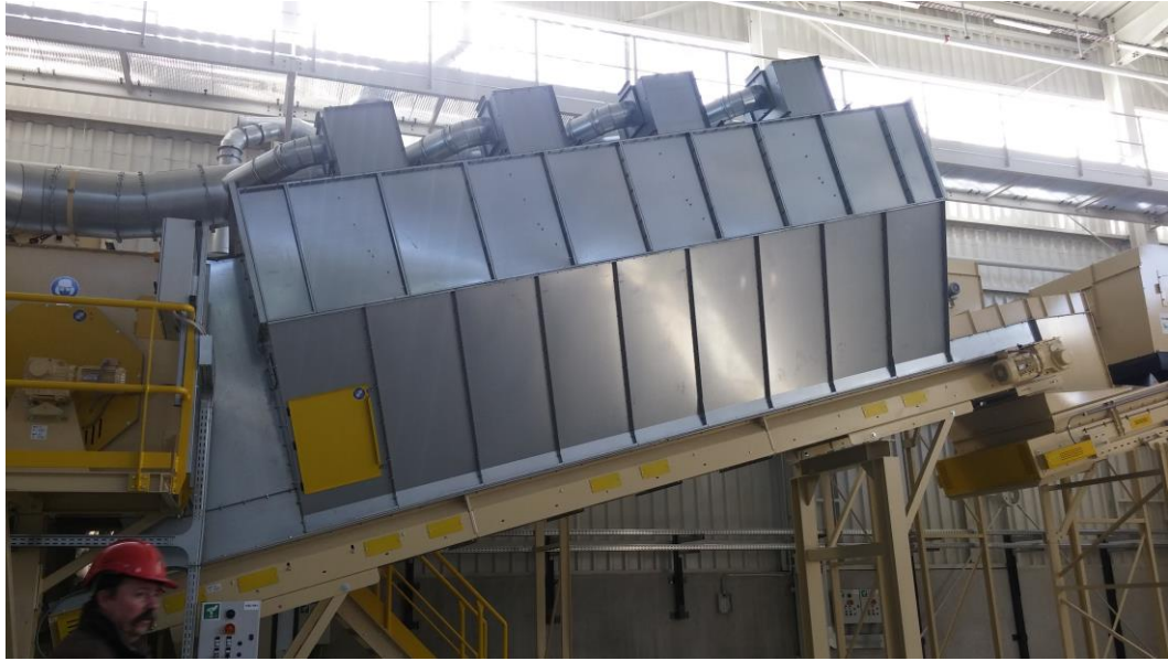
Obr. č. 13: Vibrační separátor v hale na třídění a mechanickou úpravu odpadů. Zdroj: autorka.
