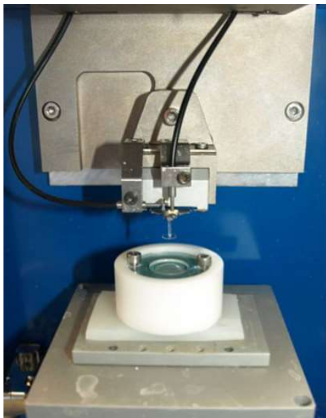
obr. 2-6 Mikrotribometr s modulem, použitý při výzkumu [17].
