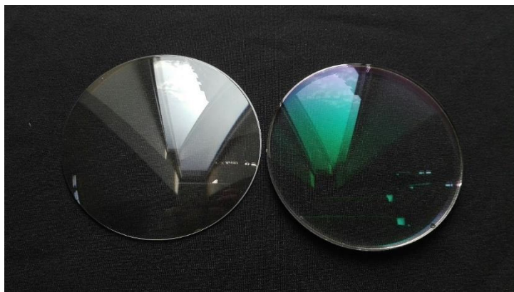
Obr. 3 – Brýlová čočka bez a s antireflexní úpravou
