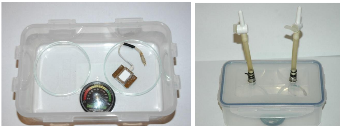
Obrázek 11: Speciálně upravený box pro karbonataci portlanditu.
