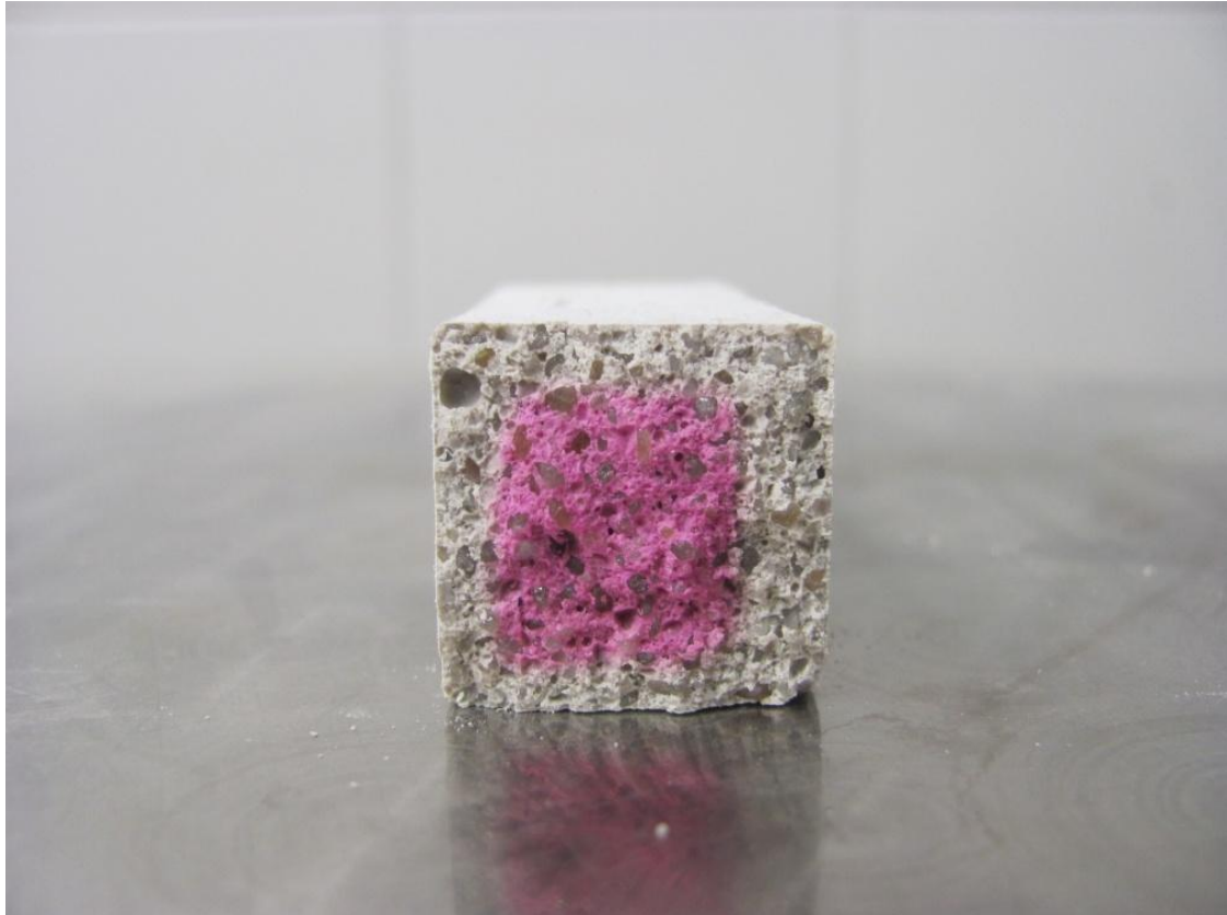
Obrázek 9: Příklad stanovení karbonatace betonu pomocí fenolftaleinové zkoušky.
