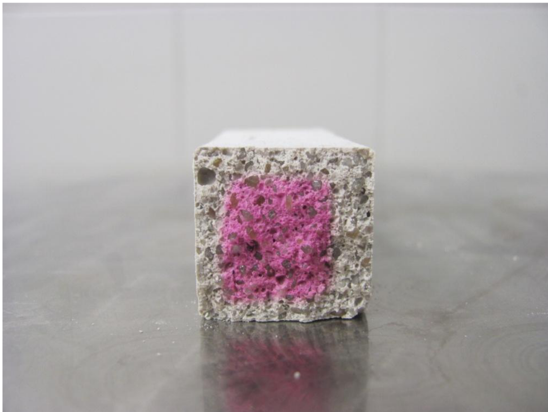
Obrázek 9: Příklad stanovení karbonatace betonu pomocí fenolftaleinové zkoušky.
