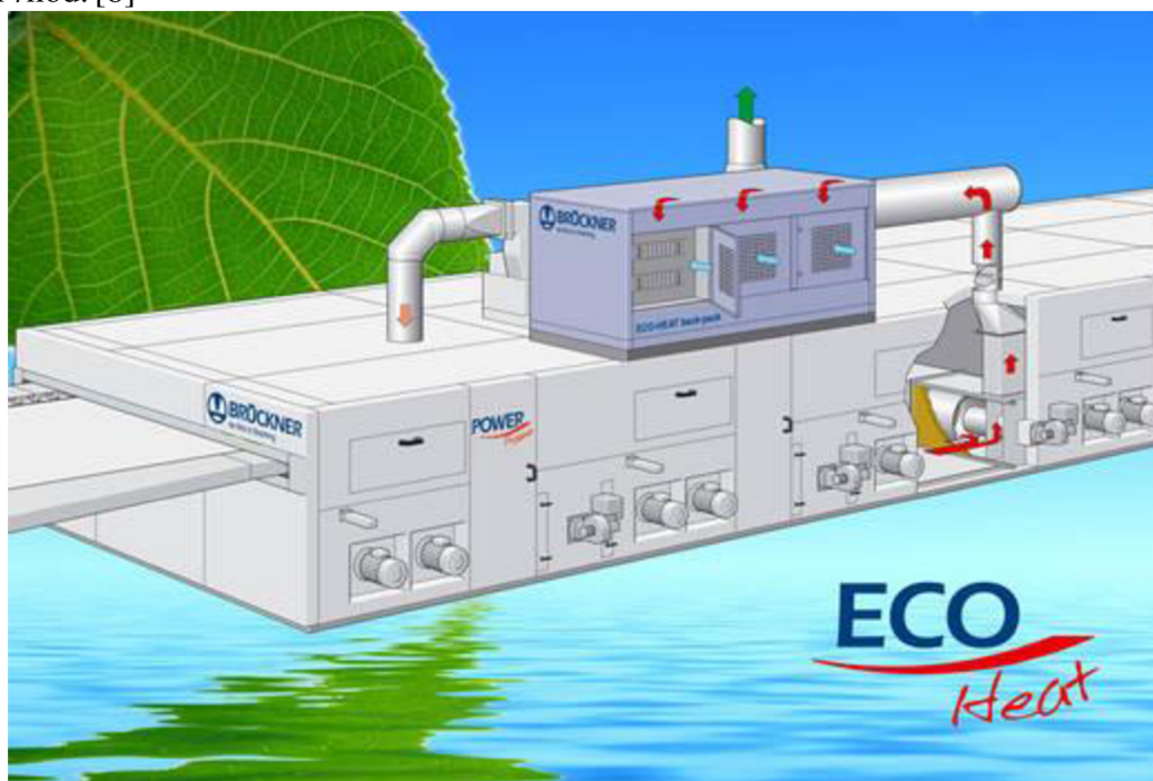
Obr. 11: Integrovaná centrální rekuperační jednotka s rozvaděčem vzduchu[16]
