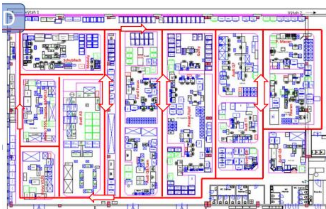
Obr. 35 Zakreslení trasy AGV, podle jeho funkcí v horním patře
