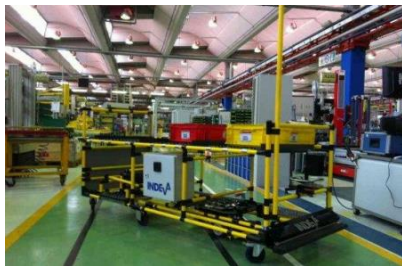
Obr. 7 AGV vozíky pro přepravu manipulačních jednotek
