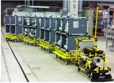
Obr. 5 AGV tahač s přivěsnými vozíky
