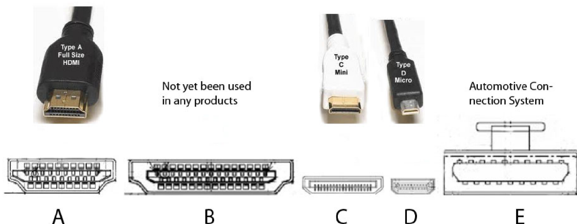
Obrázek 2.1: HDMI konektory. Převzato z [8]
