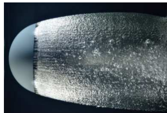
Obrázek 5: Superkavitace u koule obtékané kapalinou [4]
