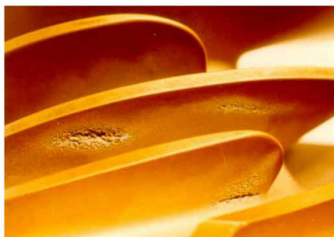
Obrázek 11: Poškození způsobené kavitační erozí [1]
