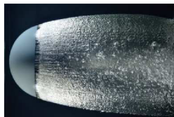
Obrázek 5: Superkavitace u koule obtékané kapalinou [4]
