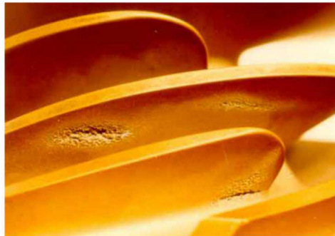
Obrázek 11: Poškození způsobené kavitační erozí [1]
