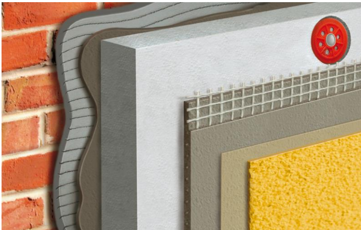
Obr. 9 – skladba vrstev zateplení, tzb-info.cz
