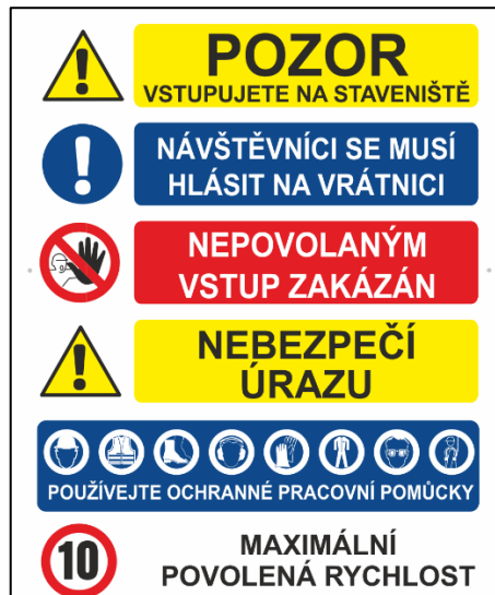
Obrázek 83: Bezpečnostní tabule staveniště
