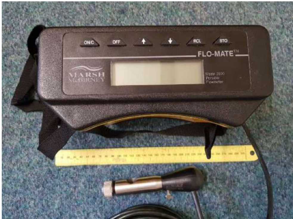
0br. 11) Měřicí sestava s měřidlem Flo-mate 2000 od firmy MARSH McBirney [6]
