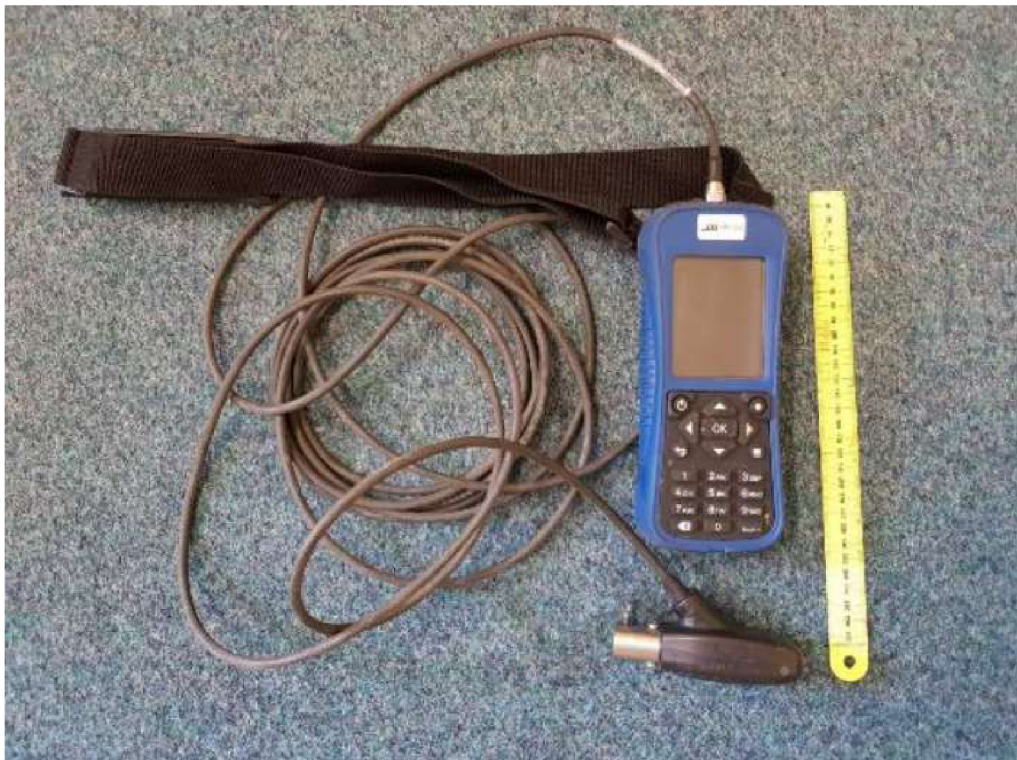
0br. 10) Měřicí sestava s měřidlem MF pro od firmy OTT hydrometr [6]
