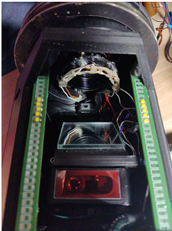
Obrázek 4.1: Náhled na zapojenou rotační hlavu, jde vidět kamera, IR komunikační kroužek, zrcátko a boční laser.
