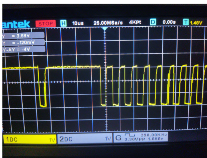
Obrázek 5.3: Přijímaný signál po zesílení z infračerveného přijímače na statické desce bez rušení z cívky.
