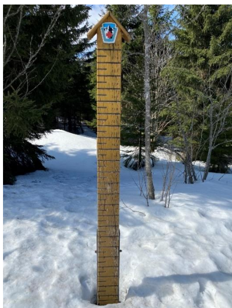
Obrázek 68 a 69 Sněhoměrný objekt s výškou sněhové pokrývky 60 centimetrů
