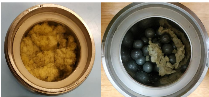
Obrázek 4.5: Výsledky mletí čedičové vaty přede mleté v ručním mixéru.
