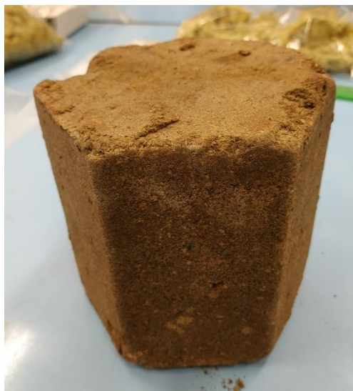
a) Čedičová cihla z výrobního odpadu
