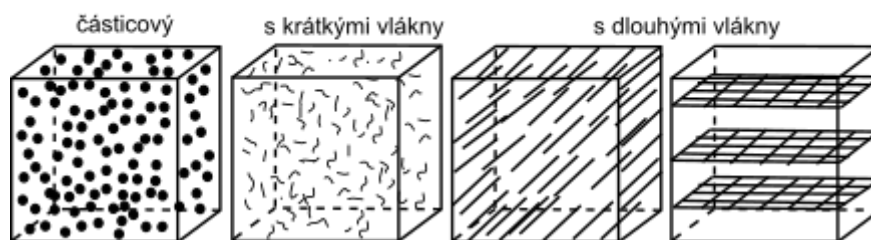
Obrázek 3.4: Kompozity s různými druhy disperze [15]
