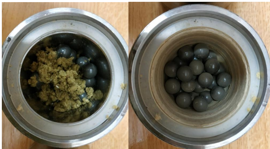
Obrázek 4.6: Výsledky mletí čedičové vaty předemleté kolovým mlýnem.
