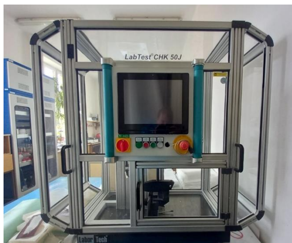
Obrázek 3.12: Testovací přístroj LabTest CHK 50J
