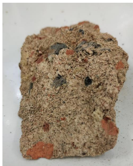
b) Ukázka vnitřní struktury čedičové cihly
