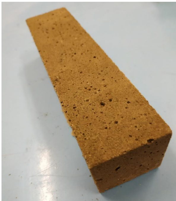
Obrázek 4.13: Hotový vzorek pro testování mechanických vlastností.
