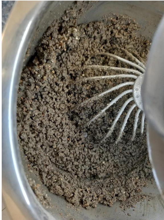
Obrázek 4.11: Příprava cementové směsi se sekanými čedičovými vlákny.
