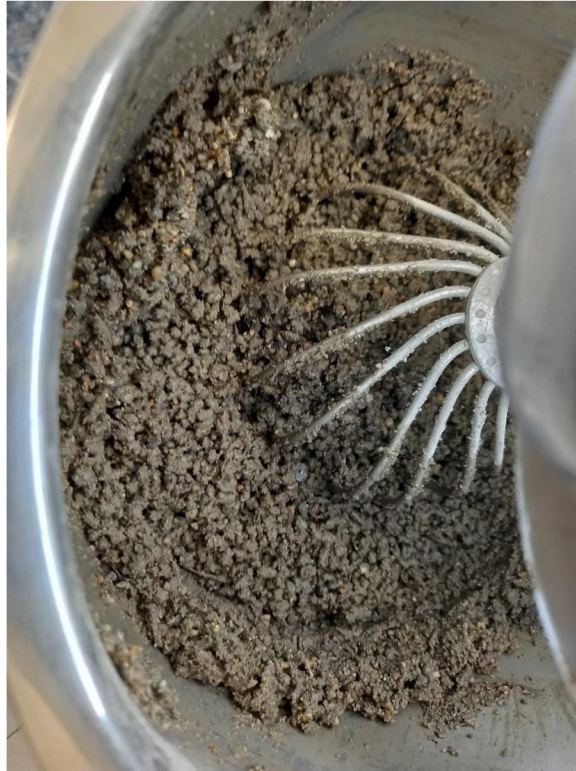
Obrázek 4.11: Příprava cementové směsi se sekanými čedičovými vlákny.
