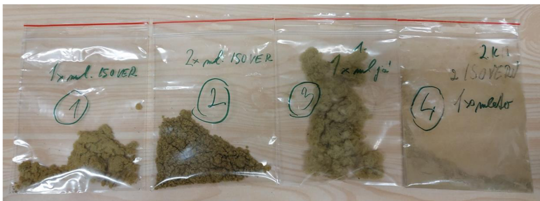
Obrázek 4.10: Vzorky čedičové vaty mleté různými způsoby, zleva: kolový mlýn jeden cyklus, kolový mlýn dva cykly, rotační čepelový mixér, planetový mlýnek.
