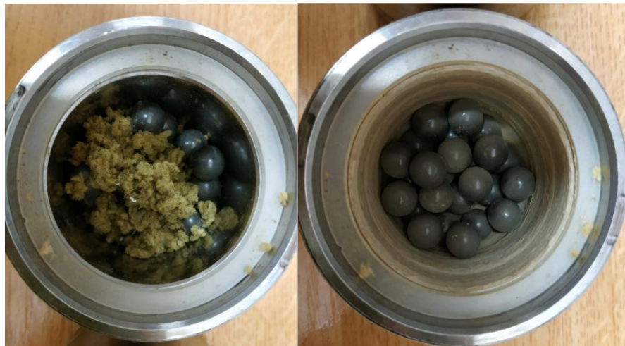
Obrázek 4.6: Výsledky mletí čedičové vaty předemleté kolovým mlýnem.
