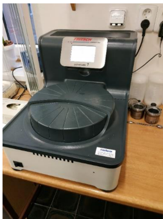
Obrázek 4.4: Planetový mlýnek Pulverisette 7 – premium line.
