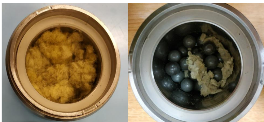
Obrázek 4.5: Výsledky mletí čedičové vaty přede mletím v ručním mixéru.
