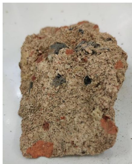
b) Ukázka vnitřní struktury čedičové cihly
