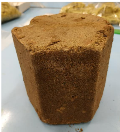
a) Čedičová cihla z výrobního odpadu
