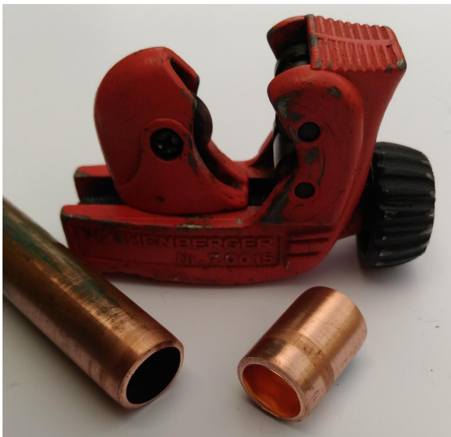
Obrázek č. 41 Krácení potrubí pomocí řezáku na měděné potrubí (foto: Oliva)
