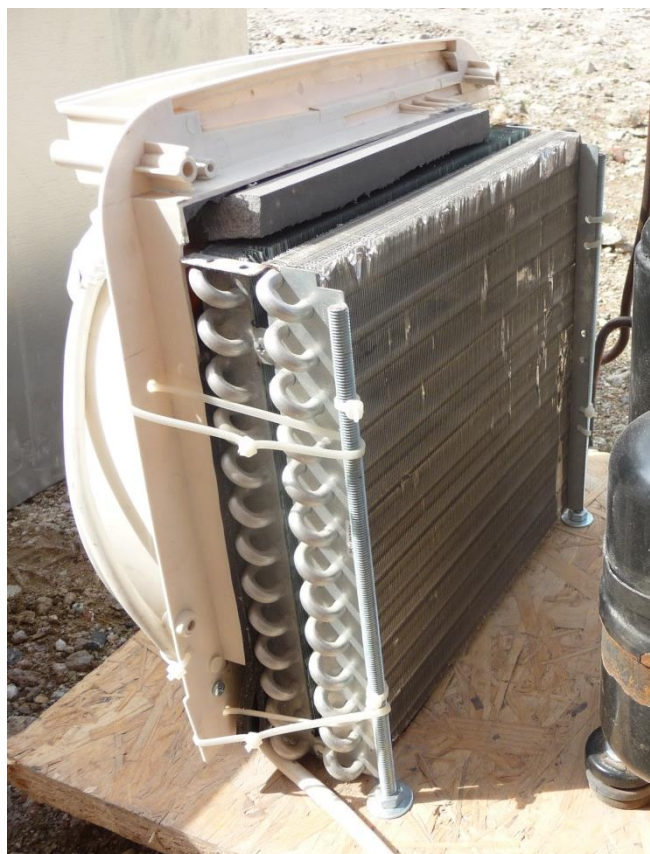
Obrázek č. 28 Kondenzátor s ventilátorem (foto: Oliva)
