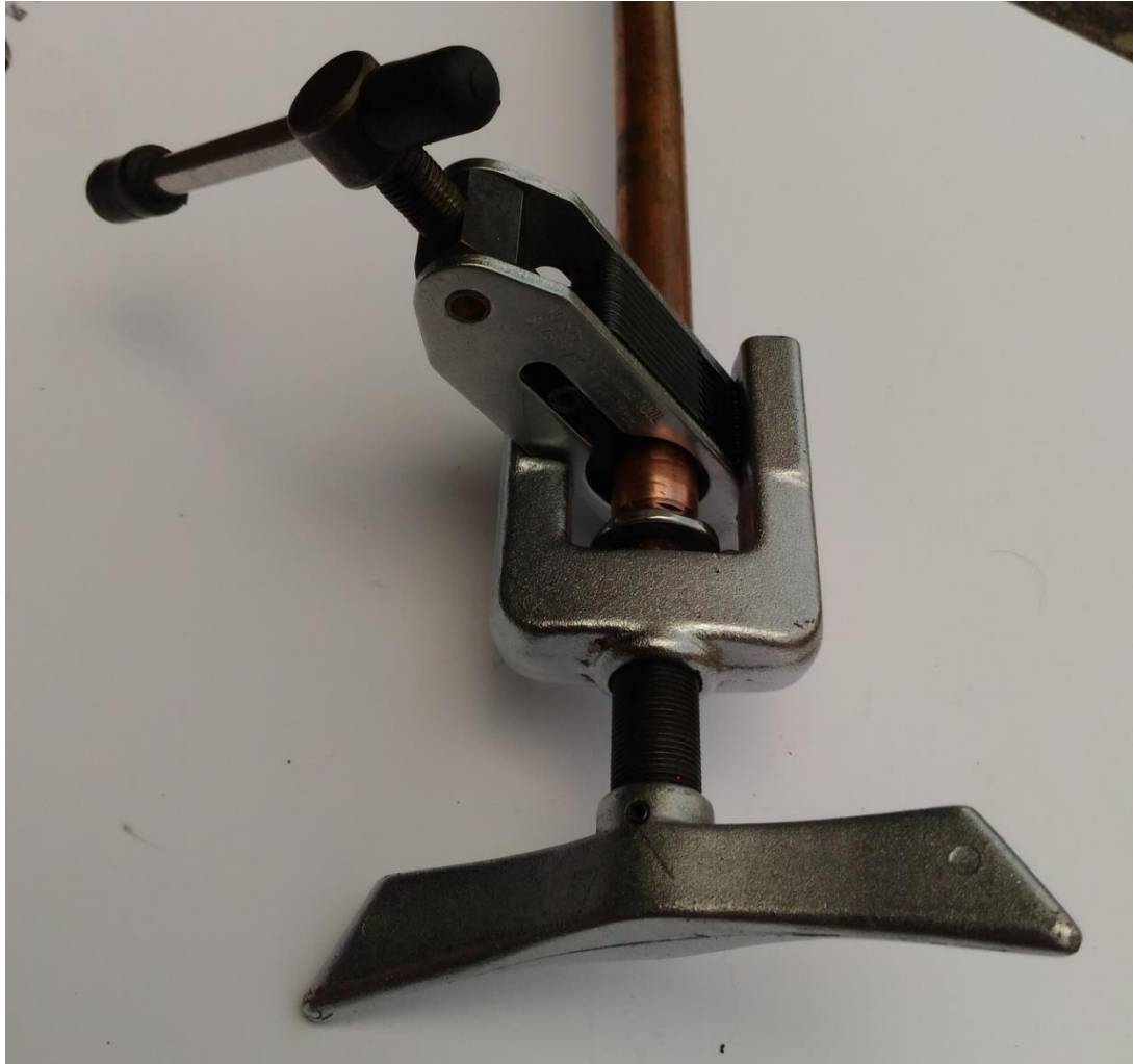
Obrázek č. 45 Výroba pertlu na měděném potrubí (foto: Oliva)
