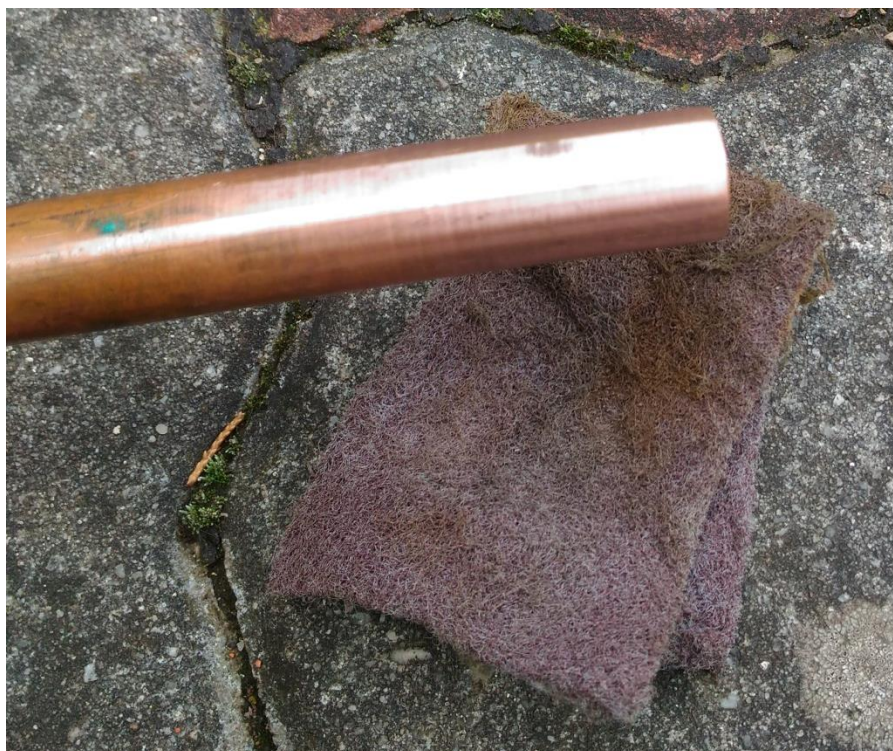
Obrázek č. 40 Měděná trubka očištěná pomocí rouna (foto: Oliva)
