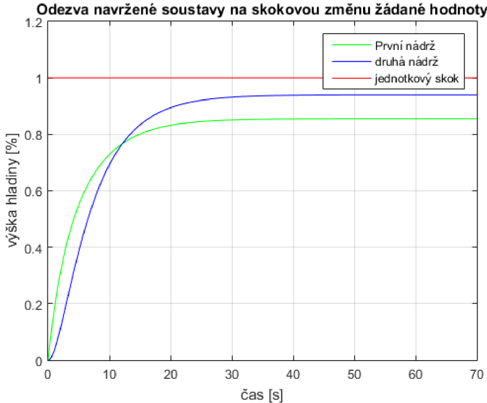
Obrázek 32: Odezva navržené soustavy na skokovou změnu žádané hodnoty
