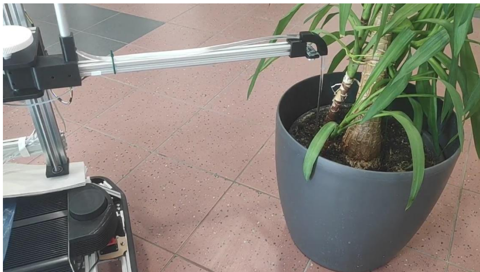
Obrázok 8.7 – Fotografia zalievajúceho modulu robota pri procese zalievania
