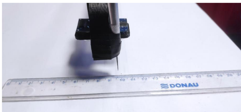
Obrázok 8.2 – Detail merania odchýlky koncového efektora pomocou hrotu a dĺžkového meradla
