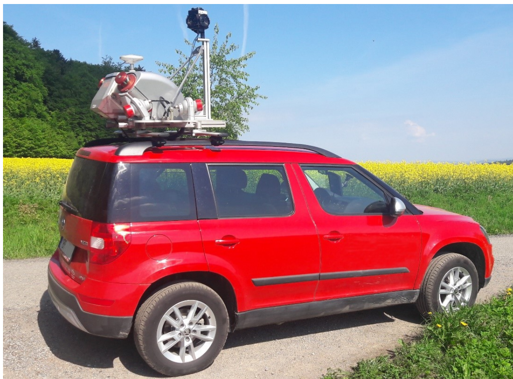
Obr. 12 Riegl VMX-450 namontovaný na střechu auta
