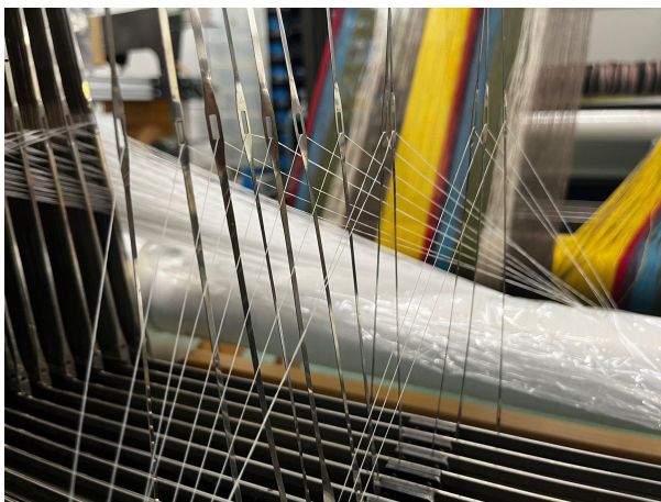
Obr. 9: Návod osnovních nití do nitěnek
