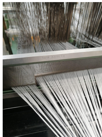
Obr. 10: Návod osnovních nití do paprsku
