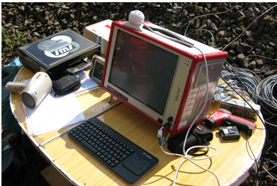
Obr. A.11 Měření akusticko-dynamických parametrů - PC sestava DEWE 2502
