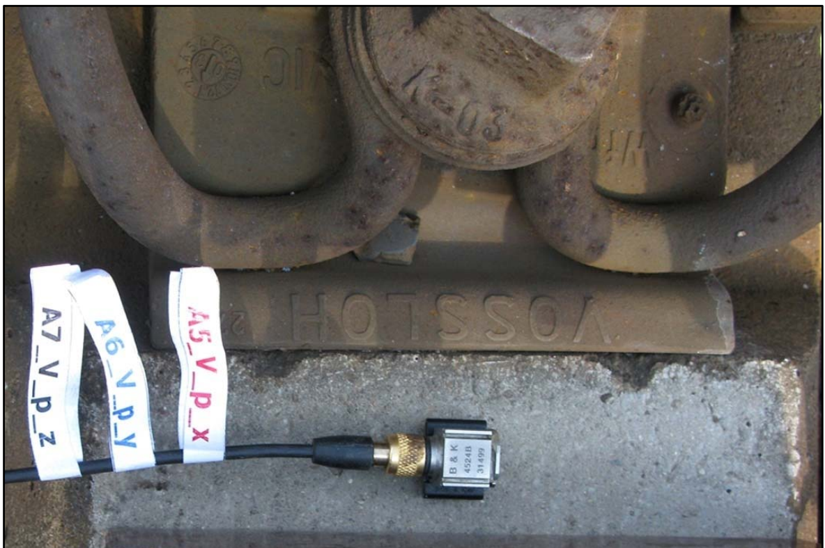
Obr. 4.7 Ukázka snímače zrychlení vibrací (akcelerometr typu 4524 B)
