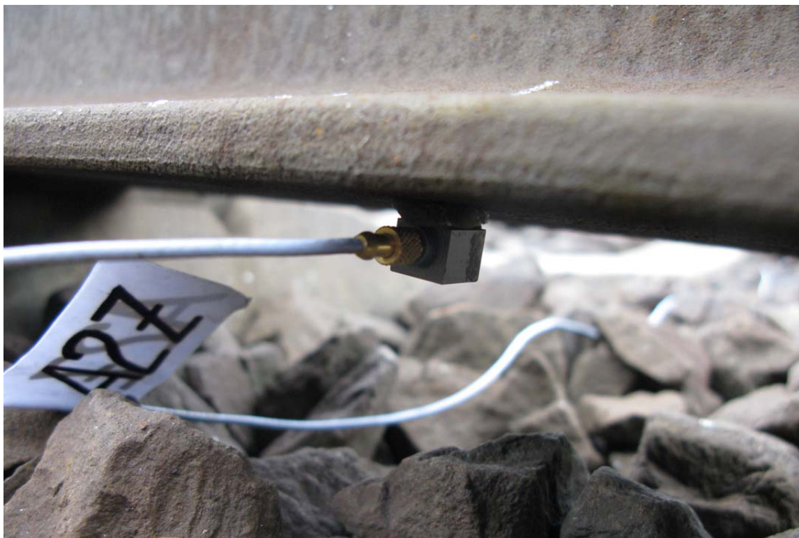
Obr. A. 7 Zkouška TDR - umístění snímače zrychlení pro svislý směr
