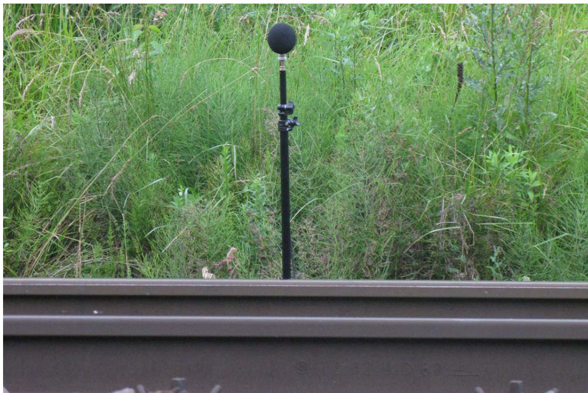
Obr. A.17 Měření akusticko-dynamických parametrů - mikrofon umístěný 7,5 m od osy koleje; ve výšce 1,2 m nad spojnici temen kolejnic (TK)
