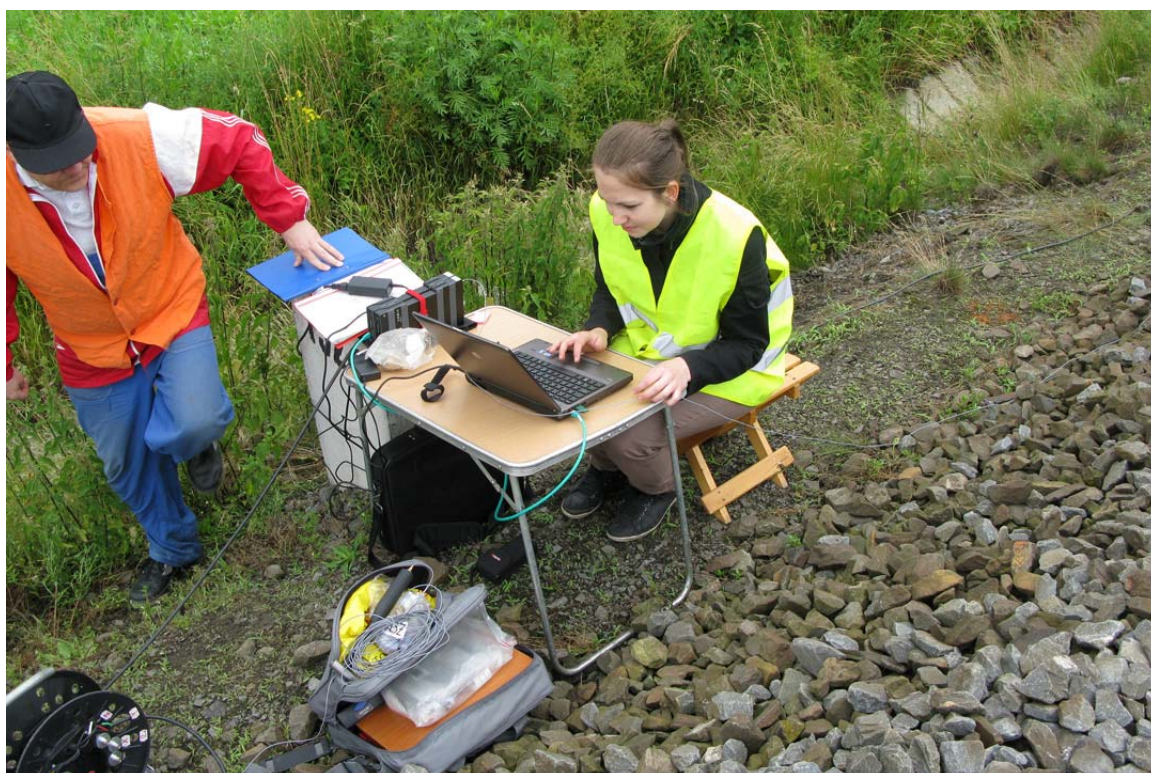
Obr. A.10 Zkouška TDR - kontrola naměřených dat; měření systémem PULSE 3560 D
