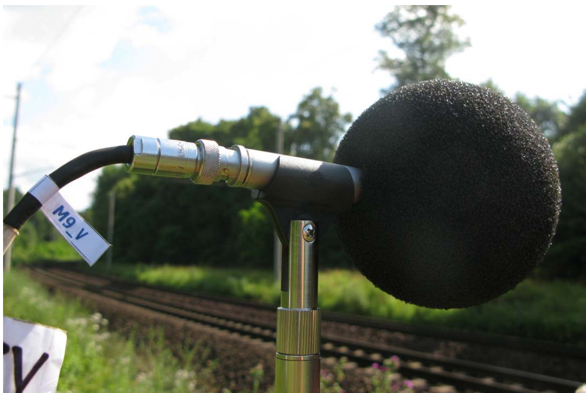
Obr. A.18 Měření akusticko-dynamických parametrů - detail mikrofonu umístěného 7,5 m od osy koleje; ve výšce 1,2 m nad spojnici temen kolejnic (TK)
