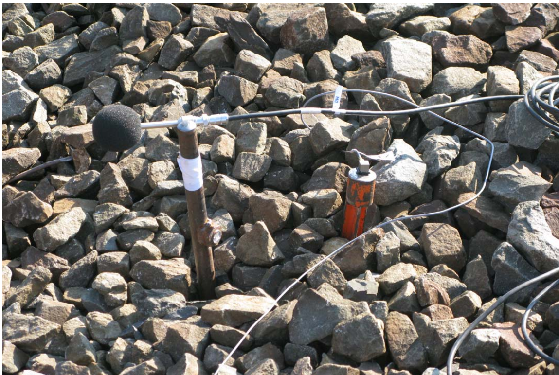
Obr. A.19 Měření akusticko-dynamických parametrů - vlevo mikrofon umístěný 1,85 m od osy koleje; vpravo akcelerometr na hraně kolejového lože
