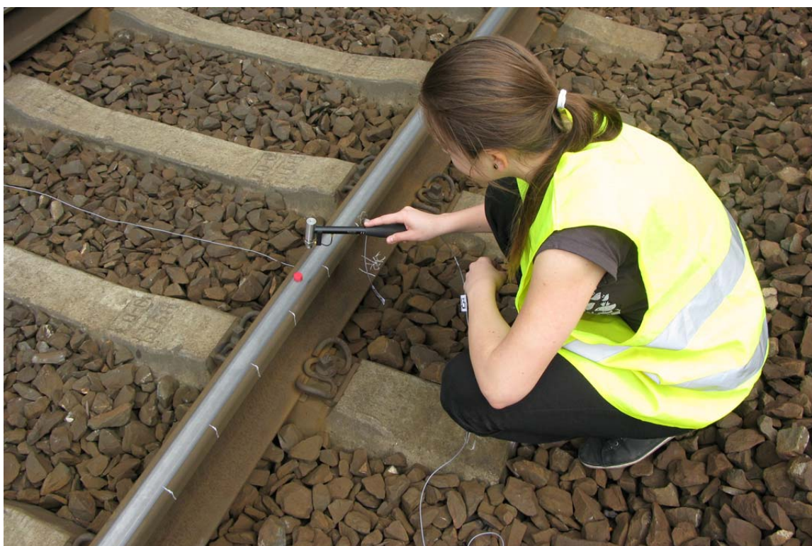
Obr. A.8 Zkouška TDR - rázové buzení; body blízkého pole
