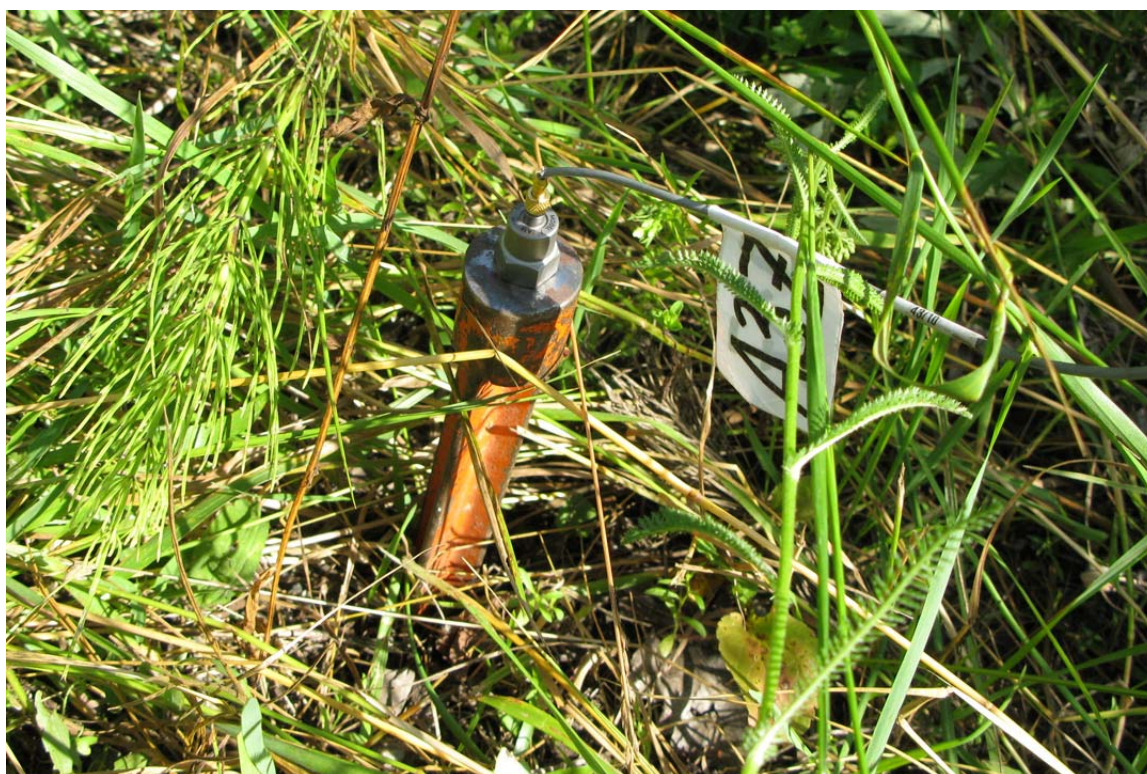
Obr. A.16 Měření akusticko-dynamických parametrů - akcelerometr umístěný ve vzdálenosti 7,5 m od osy koleje
