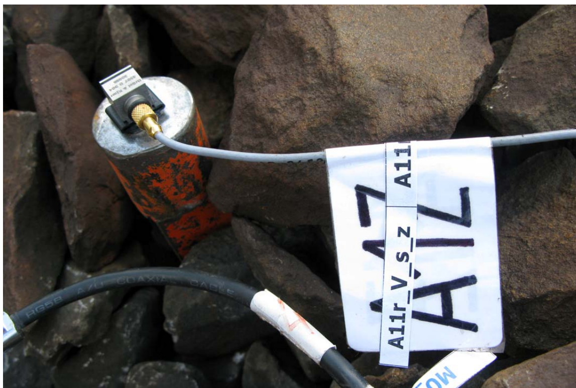
Obr. A.15 Měření akusticko-dynamických parametrů - akcelerometr umístěný na hraně kolejového lože
