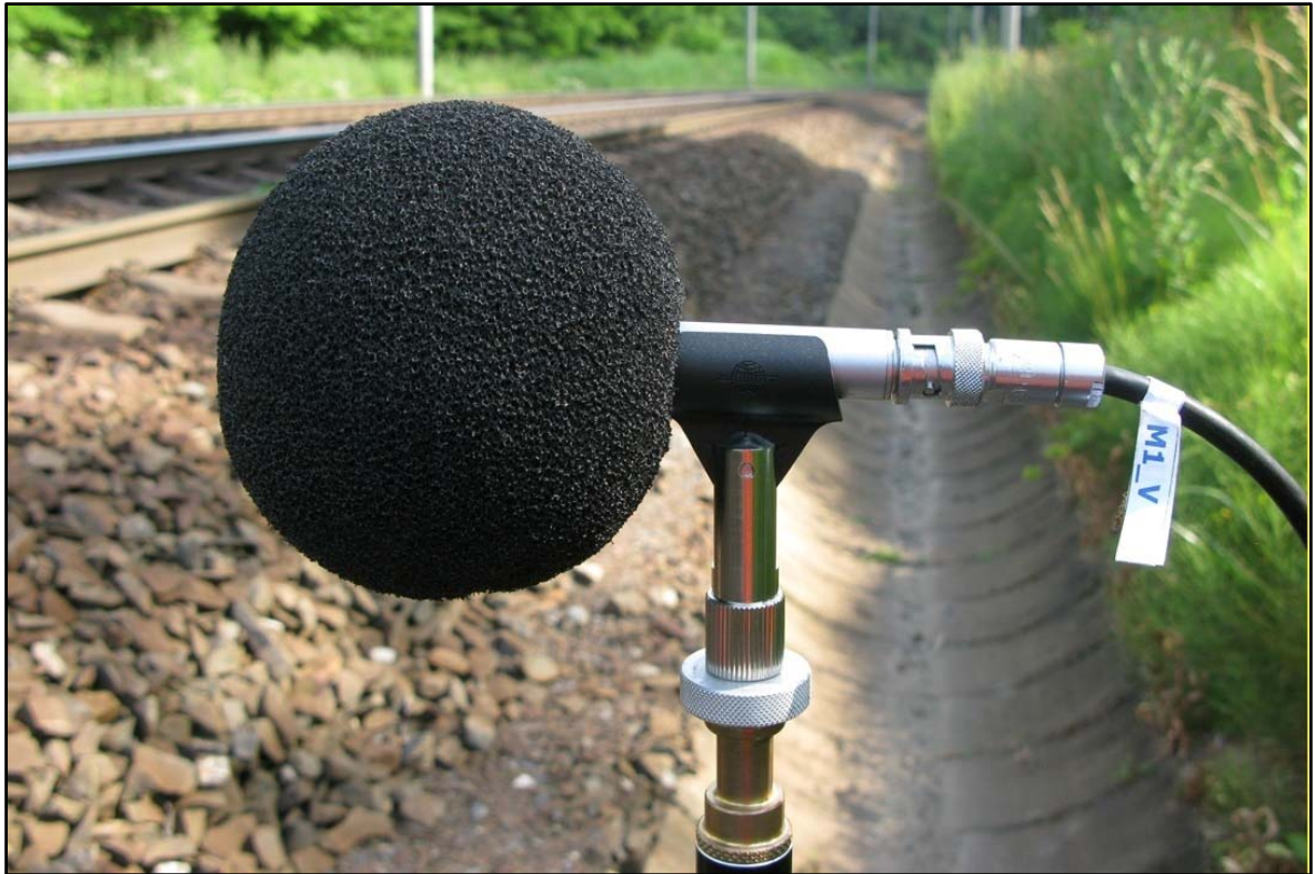
Obr. 4.6 Ukázka snímače akustického tlaku (mikrofon typu M 360)
