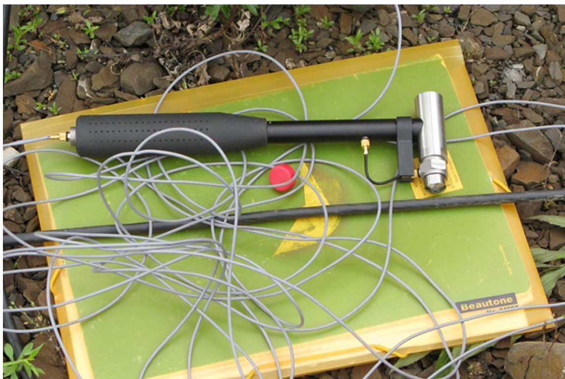
Obr. A.9 Zkouška TDR - rázové budicí kladívko typu 8202
