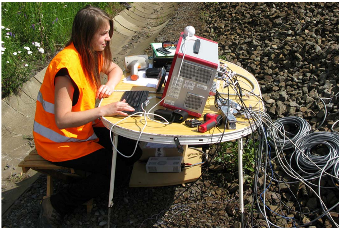
Obr. A.20 Měření akusticko-dynamických parametrů - kontrola naměřených dat
