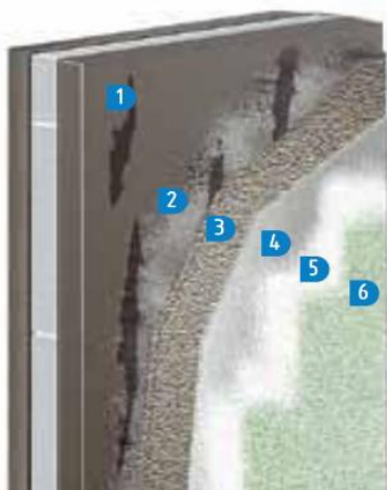
Obrázok 13- Technologický postup omietnutia betónu 34
