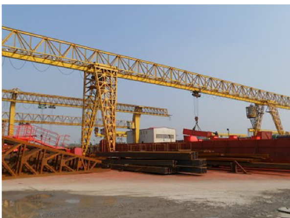
(a) Prevedenie s jedným nosníkom [3].
