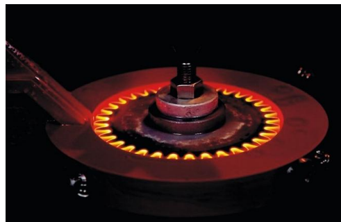
Obr. 5 Kalení ozubeného kola [34]
