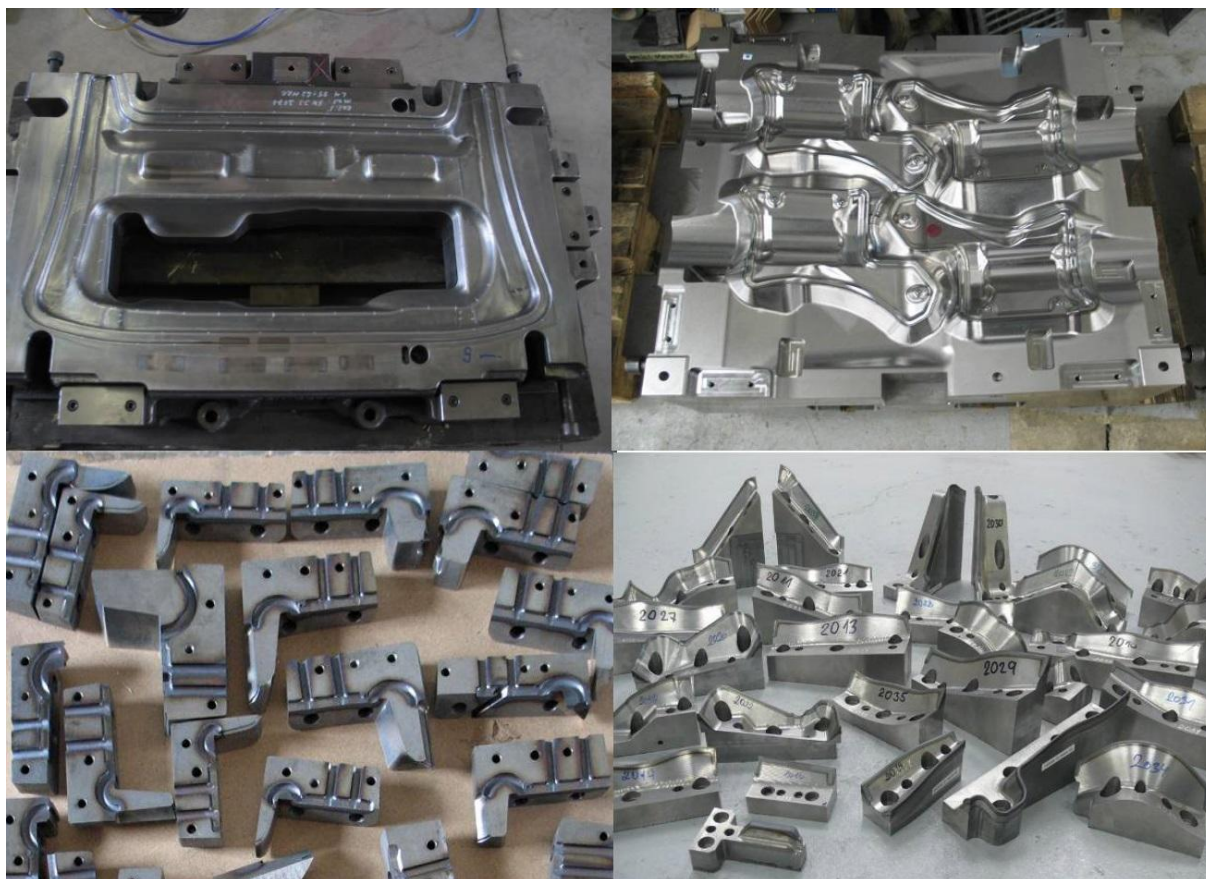
Obr. 1 Příklady povrchově kalených součástí [46]
