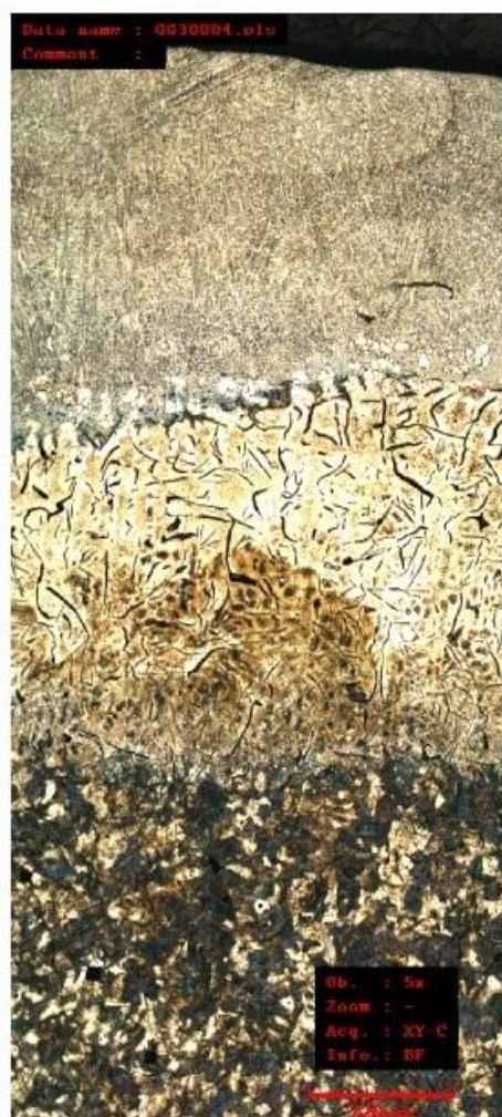
Obr. 55 Mikrostruktura celku u vzorku č. 6, při zvětšení 120x
