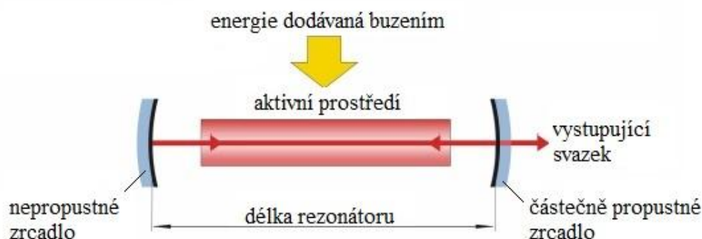
Obr. 11 Základní části laseru – rezonátor [40]
