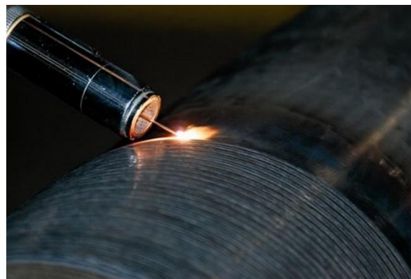
Obr. 28 Navařování povlaku pro zvýšení životnosti diodovým laserem [56]
