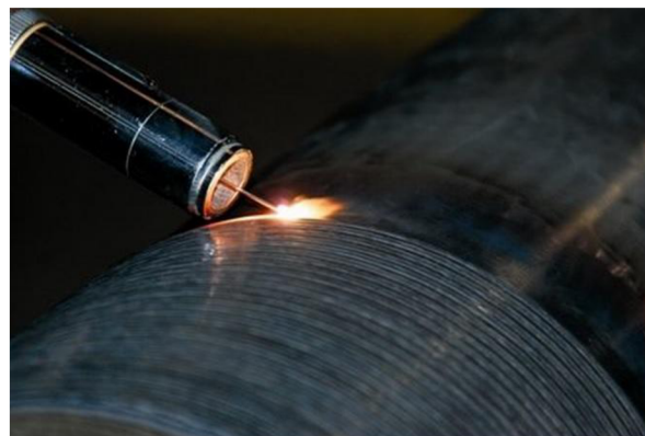
Obr. 28 Navařování povlaku pro zvýšení životnosti diodovým laserem [56]
