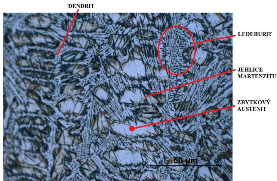
Obr. 58 Detail struktury bílé litiny, zvětšeno 1000x
