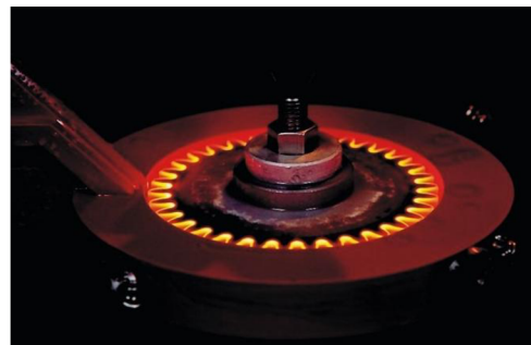
Obr. 5 Kalení ozubeného kola [34]
