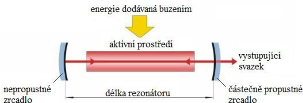
Obr. 11 Základní části laseru – rezonátor [40]
