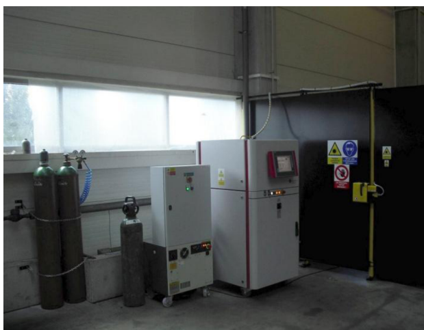
Obr. 34 Polovodičový laser ve společnosti Fermat v Brně [74]
