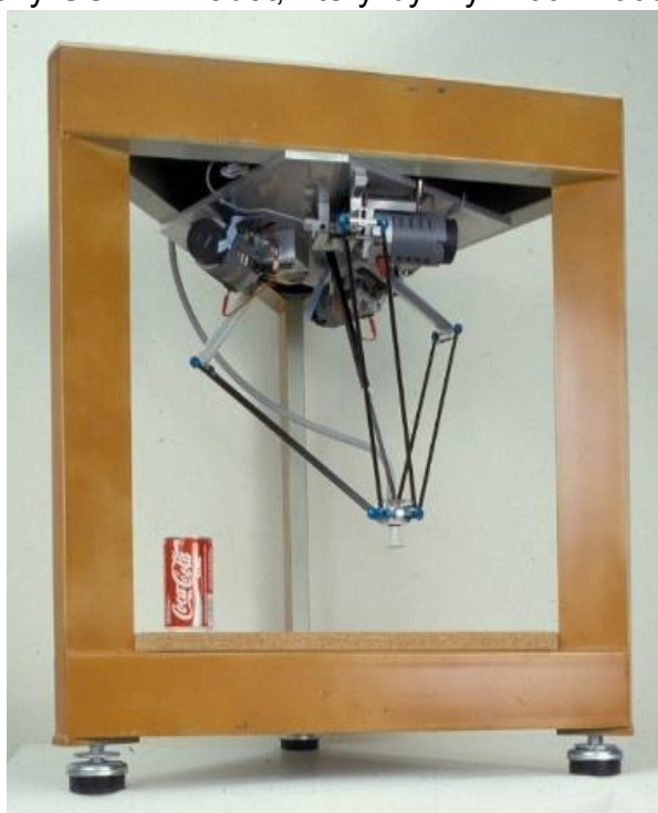
Obr. 1.9: První delta robot, vyrobený v roce 1985 [5].
