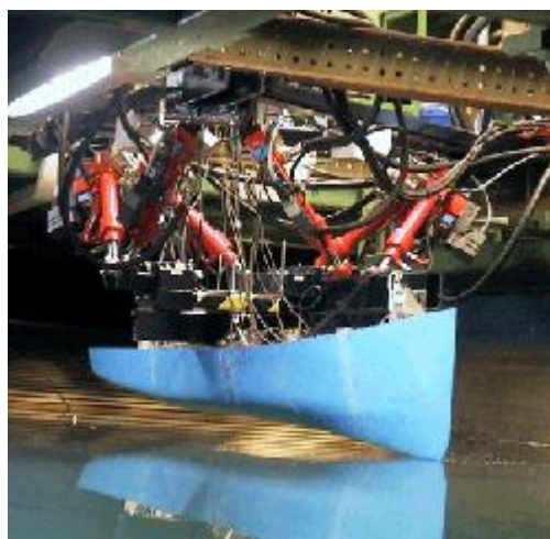
Obr. 4.12: Hexapod Hexamove testující trup lodi [25].
