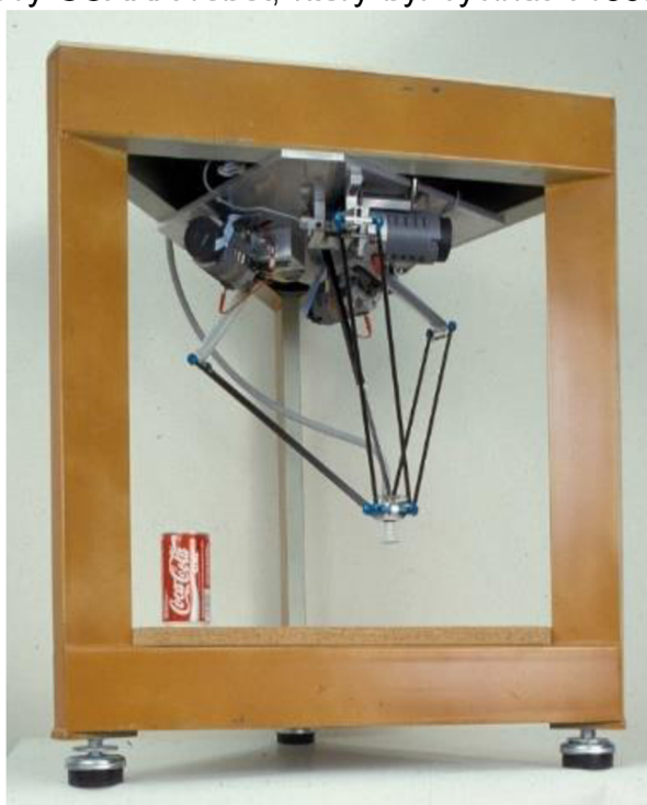
Obr. 1.9: První delta robot, vyrobený v roce 1985 [5].
